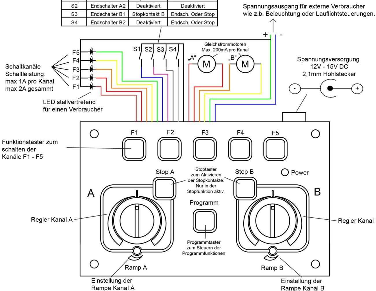
Für die folgenden Einstellungen muss das Fahrpult geöffnet werden, um Zugang zu den Bauteilen auf der Rückseite der Steuerung zu erhalten. Dazu entfernen Sie die 4 Schrauben der Frontplatte und ziehen diese vorsichtig aus dem Gehäuse.
